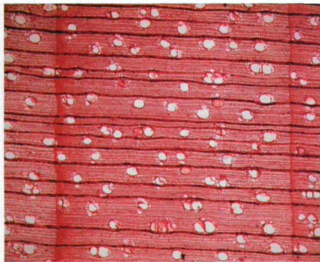
〔图十一〕金丝楠木横切面细胞照片
